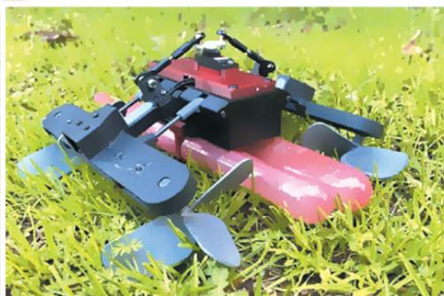
Робот, созданный по примеру ящерицы, способен передвигаться как по суше...
