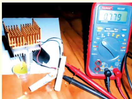
Рис. 2. Эксперимент со свечкой и термоэлектрогенератором.
